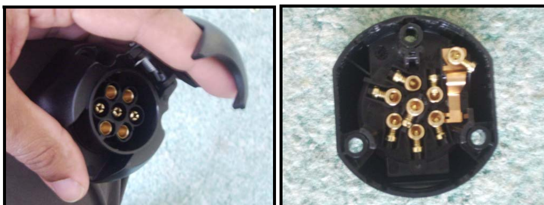
Figure 6 : Photos de la prise électrique.
