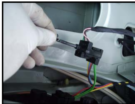
Figure 41 : Photo du serrage avec le collier.
