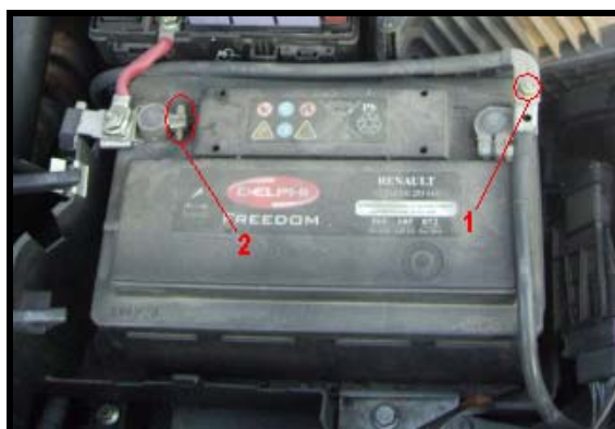
Figure 8 : Photo illustrant la déconnexion de la batterie.
