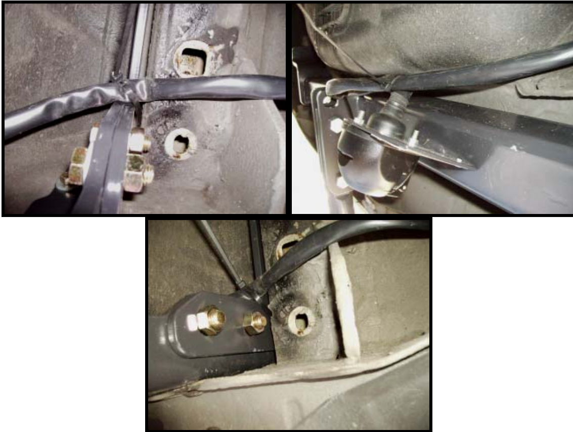
Figure 51 : Photos de la fixation du câble de la prise de l'attelage.
