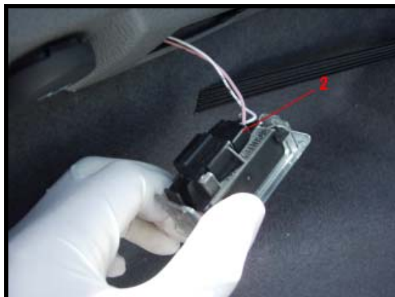
Figure 30 : Photo du connecteur électrique du bloc d'éclairage du coffre.
