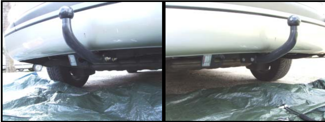
Figure 23 : Photos illustrant l'attelage après la première phase de montage.
