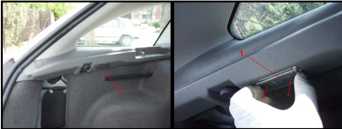
Figure 29 : Photos montrant l'extraction du bloc d'éclairage du coffre.
