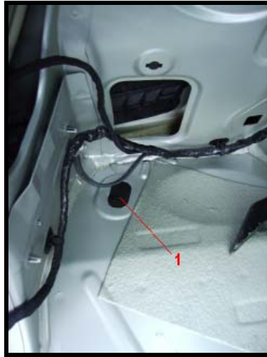
Figure 36 : Photos du pré-découpage et du trou effectué pour le passage du câble.
