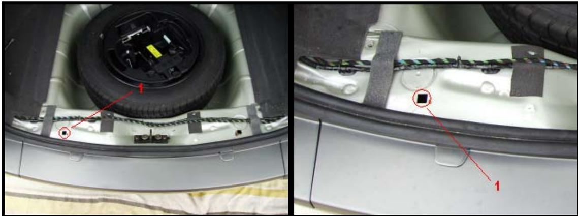
Figure 30 : Photos du trou carré pour le passage des câbles.
