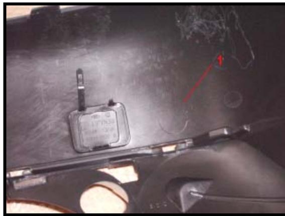
Figure 11 : Photo de la zone d'origine du radar de recul.
