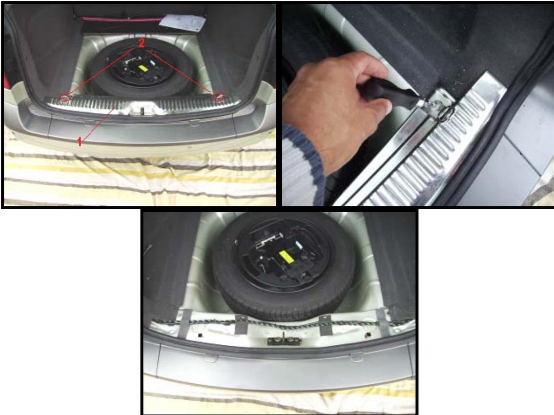
Figure 21 : Photos du retrait de la pièce de maintien et de protection.
