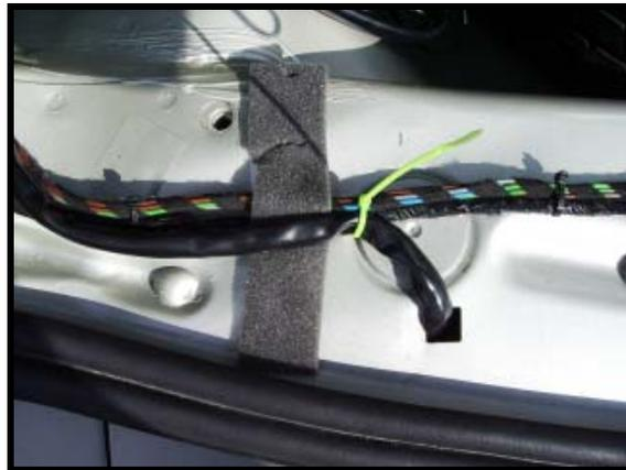
Figure 43 : Photos de la fixation du câble.
