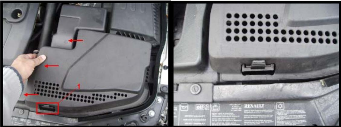
Figure 5 : Photos illustrant le retrait de la protection de la batterie.
