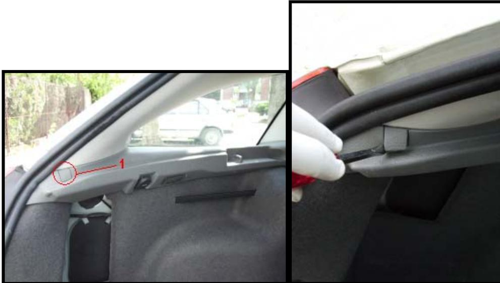
Figure 25 : Photos du cache de la vis de fixation de la garniture.
