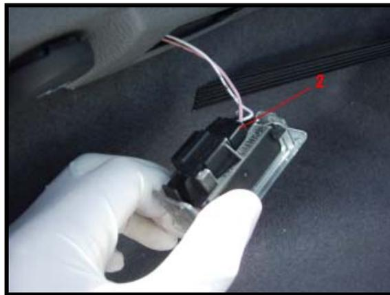
Figure 24 : Photo du connecteur électrique du bloc d'éclairage du coffre.
