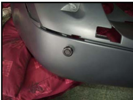
Figure 18 : Photos du test d'insertion du capteur.
