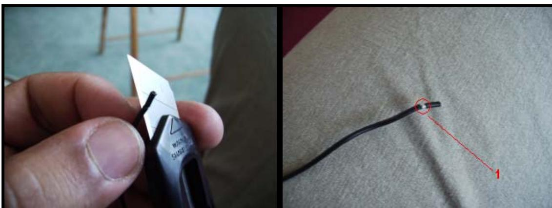
Figure 39 : Photos illustrant le dénudage d'un câble.
