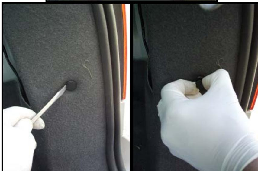
Figure 28 : Photos de la pièce de fixation des garnitures et de son extraction.
