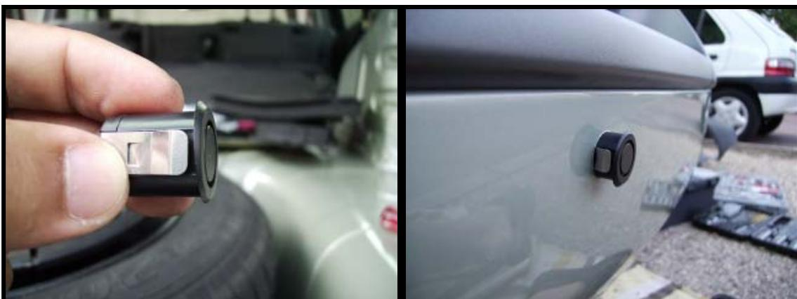
Figure 33 : Photos d'un capteur et de sont insertion.
