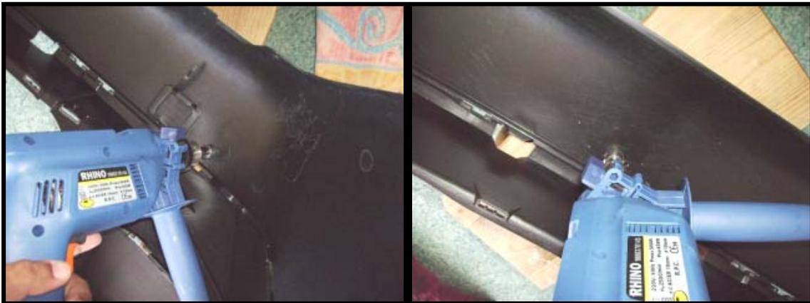
Figure 16 : Photos montrant le perçage du pare-choc.
