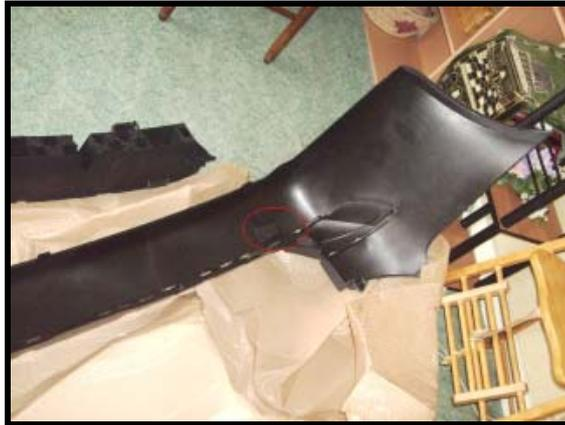
Figure 10 : Photo du pare-choc et de l'ouverture pour l'anneau de tractage.
