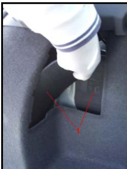
Figure 27 : Photo montrant l'extraction d'une mousse de protection.
