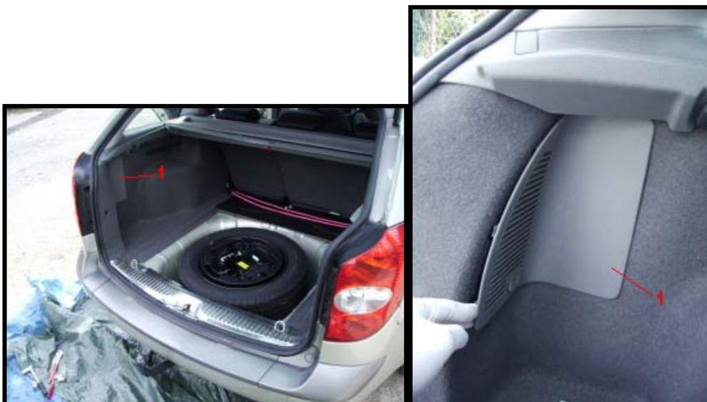
Figure 22 : Photos de la protection du bloc de feux arrière.
