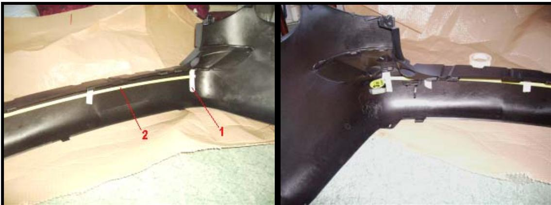
Figure 12 : Photos de la mesure des distances entre les capteurs.
