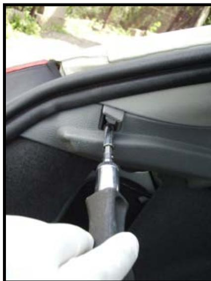
Figure 26 : Photo du dévissage de la vis de fixation de la garniture.
