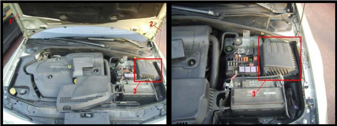
Figure 4 : Photos précisant l'endroit où se trouve le filtre à air.
