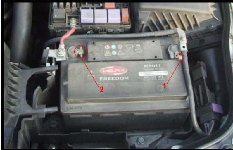
Figure 6 : Photo illustrant la déconnexion de la batterie.
