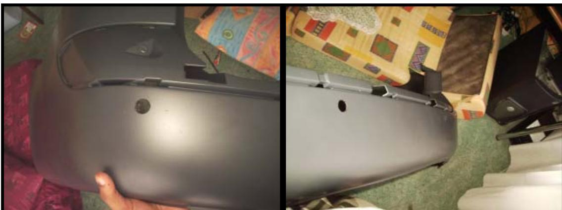
Figure 17 : Photos des trous devant accueillir les capteurs.
