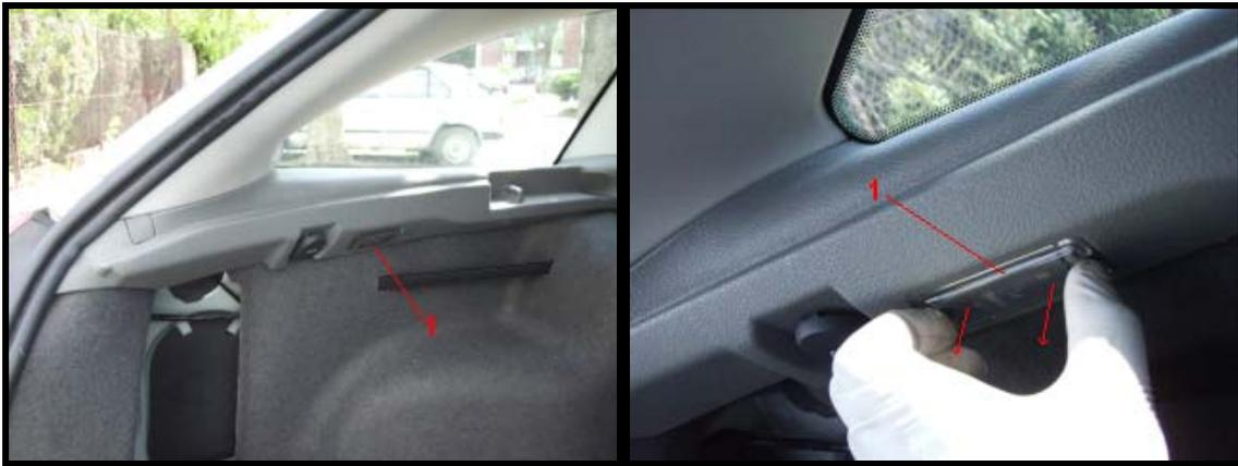
Figure 23 : Photos montrant l'extraction du bloc d'éclairage du coffre.
