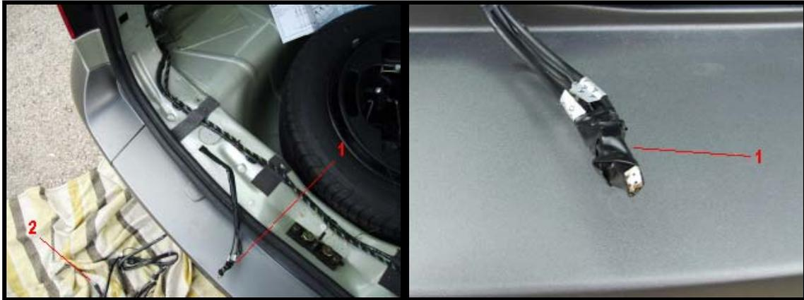
Figure 31 : Photos des câbles passés par les trous.
