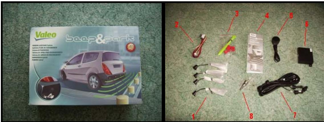
Figure 2 : Photos de la boîte du radar de recul et de son contenu.
